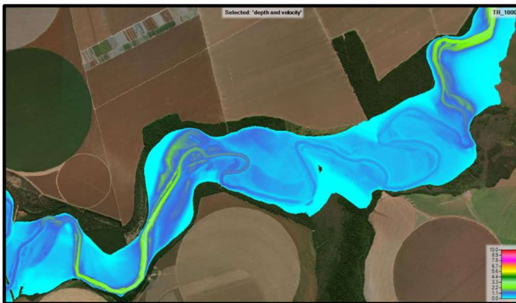
Figura 08 - Resultado mancha de inundação com mapa do produto da velocidade com profundidade (m 2 /s).
