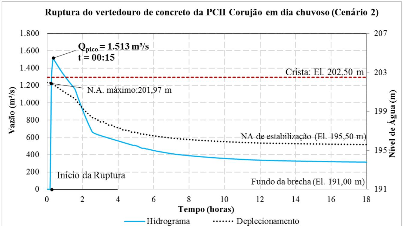
Figura 10 - Hidrograma de ruptura PCH Corujão – Ruptura do vertedouro de concreto em dia chuvoso (Cenário 2)
