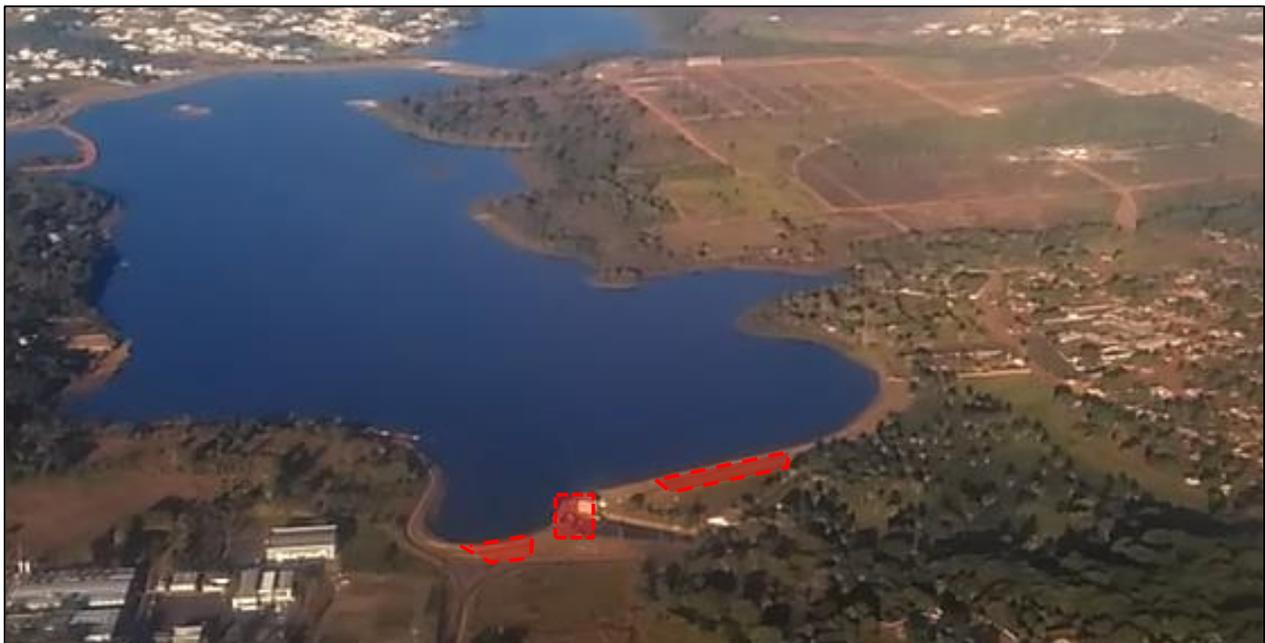
Figura 6 - Vista aérea da posição das brechas de ruptura
