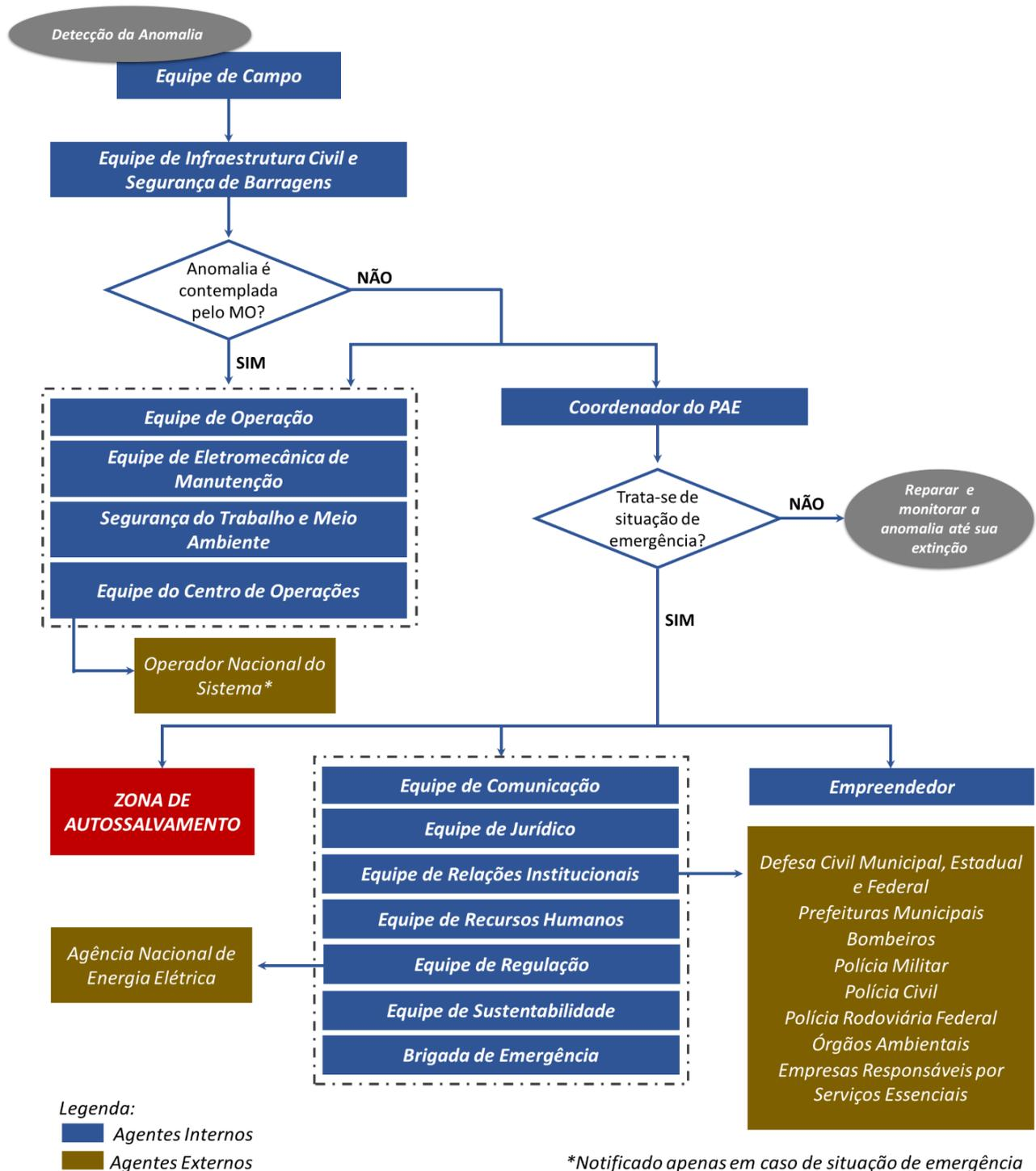
Figura 5 - Fluxograma geral de notificação de anomalias
