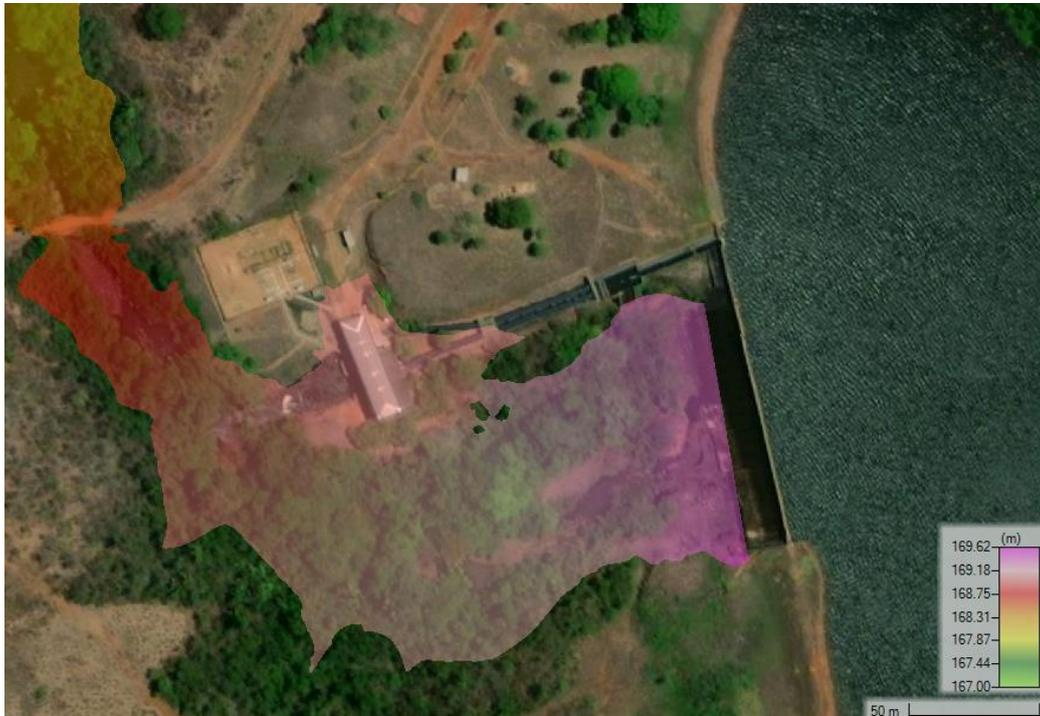
Figura 14 – Envoltória dos níveis máximos – Montante da ponte BR-153 (~20 minutos)
