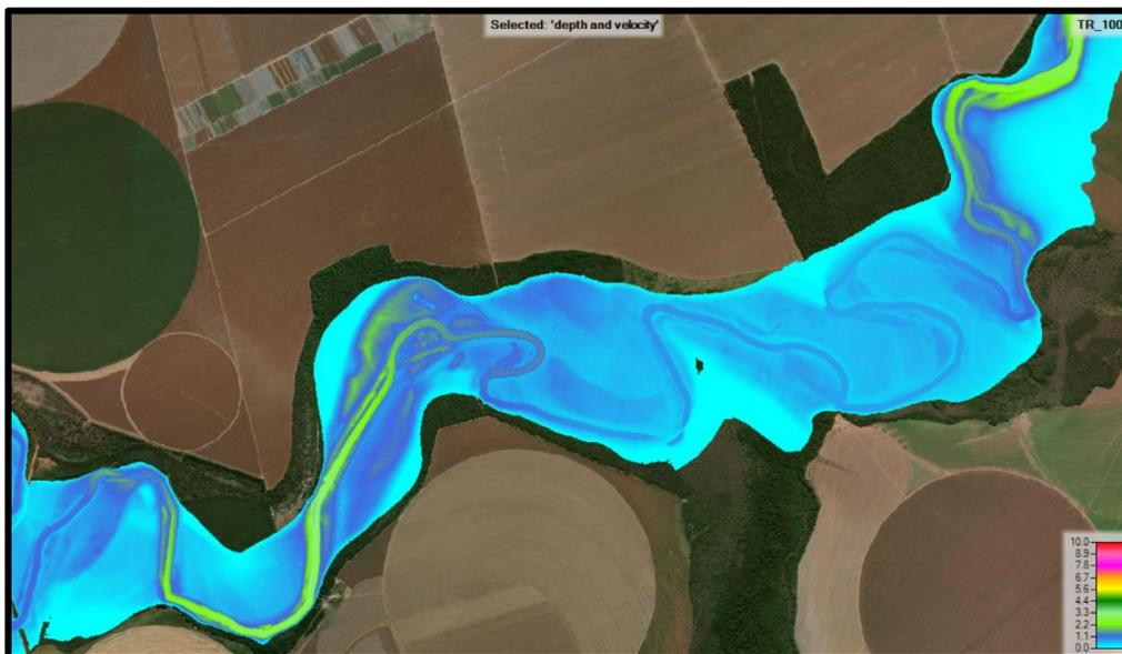
**Figura 08 - Resultado mancha de inundação com mapa do produto da velocidade com profundidade (m<sup>2</sup>/s).**
