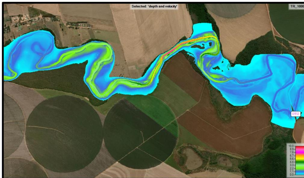
**Figura 07 - Resultado mancha de inundação com mapa do produto da velocidade com profundidade (m<sup>2</sup>/s).**
